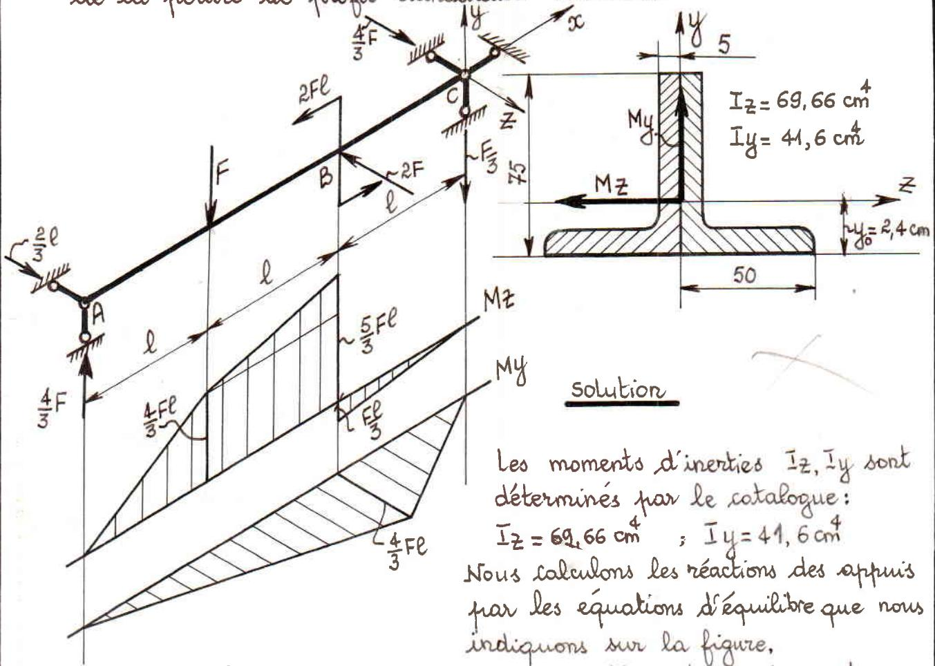
Nous traçons les diagrammes des moments fléchissants  $M_z$  et  $M_y$  et nous remarquons que la section "B" est la plus sollicitée.
