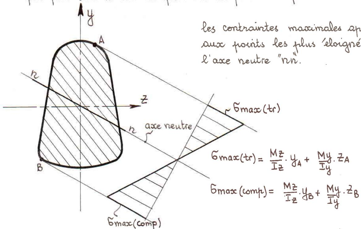
les contraintes maximales apparaissent aux points les plus éloignés de l'axe neutre "nn".
