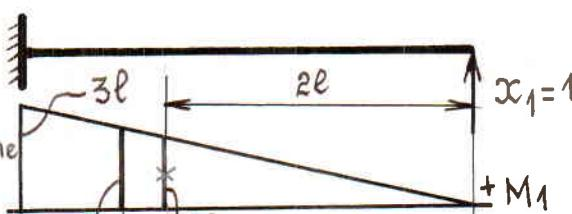
$\delta_{1F}$  se détermine en multipliant le diagramme " $M_1$ " par " $M_F$ "
