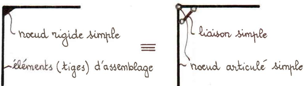
Comme l'indique la construction, le noeud rigide simple est équivalent au noeud articulé simple appuyé par une liaison simple.
